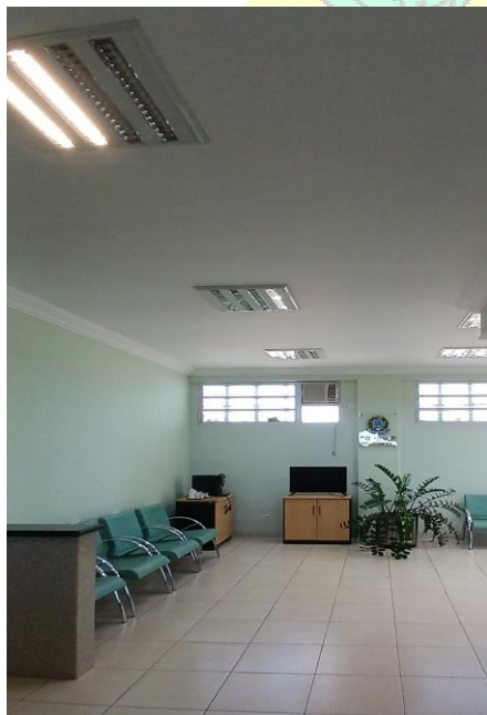
Figura 1 – Sala de Atendimento (Local onde serão desinstaladas as lâmpadas fluorescentes T5/reatores e instaladas as lâmpadas LED TUBE 8W T5 BIVOLT 6500K)
