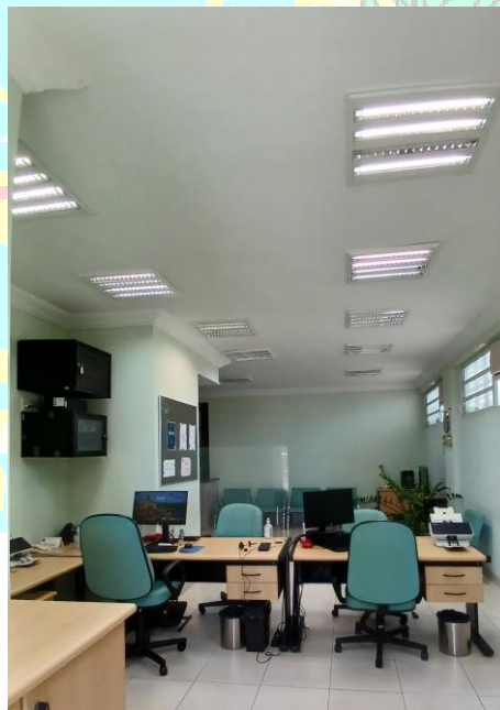
Figura 2 – Sala de Atendimento (Local onde serão desinstaladas as lâmpadas fluorescentes T5/reatores e instaladas as lâmpadas LED TUBE 8W T5 BIVOLT 6500K)
